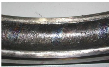
图 1 故障轴承外圈滚道
